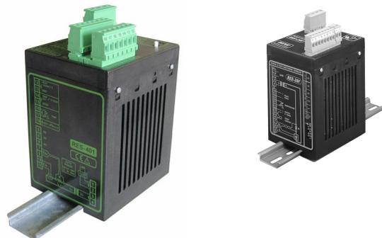
Der RESISTRON-Temperaturregler RES-401 kann als Ersatzgerät für den Regler RES-201-0-3 verwendet werden.
